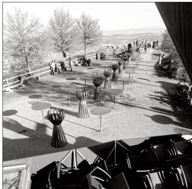
Die Bar-Tische stecken in 30 cm hohen Hülsen, die im Boden verankert und deshalb nicht mobil sind.
